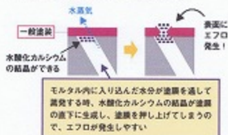
【タイル表面をコーティングした一般の塗料の場合】
